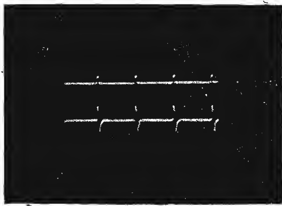
Fig. 22. — Impulsi sincronizzanti di riga e gli stessi dopo differenziazione (fotografia Laboratori Unda Radio).
